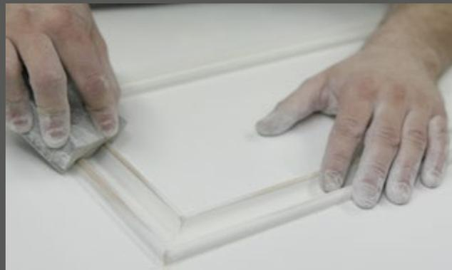
Beim Schleiflackverfahren werden mehrere Lackschichten mit jeweiligem Zwischenschliff aufgetragen. Jeder Zwischenschliff wird mit zunehmend feiner werdendem Schleifpapier ausgeführt, so dass eine besonders homogene und glatte Oberfläche entsteht. Durch die Handlackierung werden filigrane und profilierte Oberflächen sauber lackiert, Übergänge zwischen Profil und Fläche dauerhaft verfüllt und dadurch das Entstehen von Haarrissen vermindert.
