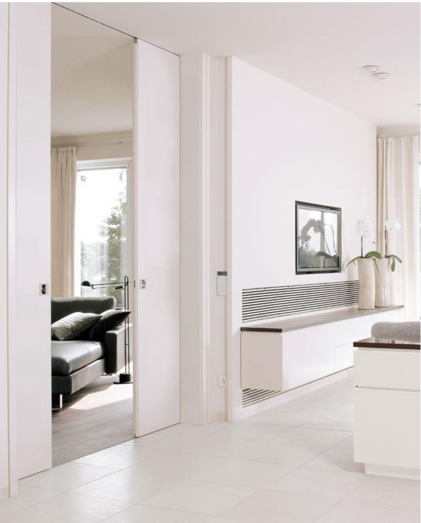
Doppelschiebetür Typ G | verdecktliegende Schiebetürschiene | Schleifack RAL 9016 | Zarge raumhoch ohne Querstück K50
