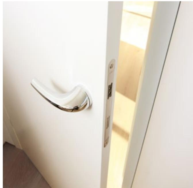
Das Magnetschloss bietet den Vorteil, dass kein mechanischer Kontakt zwischen Falle und Schließblech zum Schließen nötig ist. Dadurch kann das Schließblech in die Zarge eingelassen werden und ist bei geschlossener Tür nicht sichtbar. Weiterer Vorteil ist ein deutlich reduziertes Schließgeräusch.
