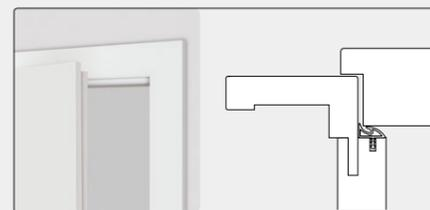
Bei der gefälzten Ausführung liegt das Türblatt auf der Bekleidung auf.
