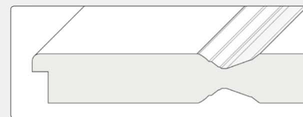
Türblatt mit liegenden Hohlprofilen, Einlage aus Röhrenspanplatten
