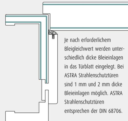
Je nach erforderlichem Bleigleichwert werden unterschiedlich dicke Bleieinlagen in das Türblatt eingelegt. Bei ASTRA Strahlenschutztüren sind 1 mm und 2 mm dicke Bleieinlagen möglich. ASTRA Strahlenschutztüren entsprechen der DIN 68706.
